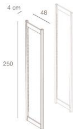
9SS DX-SX Nr.1 spalla destra o sinistra per self standing telaio tubo quadro 40x40 mm Nr.1 structure left or right for self standing frame in 40x40 mm squared tube L.4 x P.48 x H.250 cm
